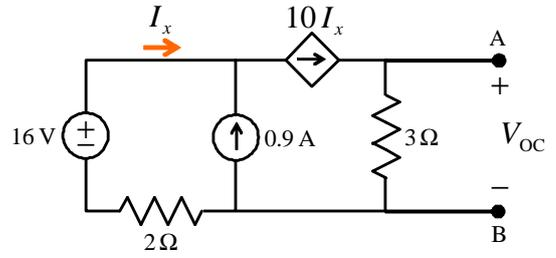
Aplicando la ley de Ohm en la resistencia de  $3\ \Omega$  tenemos  $V_{OC} = 3 \times 10I_x$ , donde  $I_x$  conserva el mismo valor obtenido anteriormente. Por tanto
