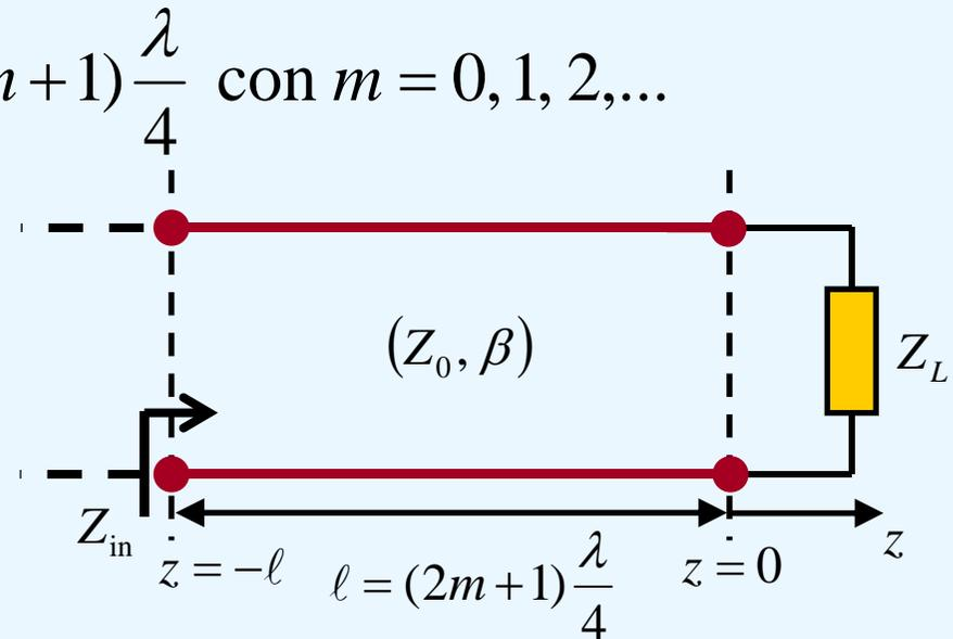
Ejemplo 7: Una línea de impedancia  $Z_0 = 50 \Omega$  esta terminada en una carga de  $Z_L = 100 \Omega$ . Como consecuencia se producen reflexiones en la carga. Para eliminar estas reflexiones (adaptar la carga a la línea) se emplea un transformador  $\lambda/4$  como se indica en la figura. Determinar la impedancia característica de dicho transformador.
