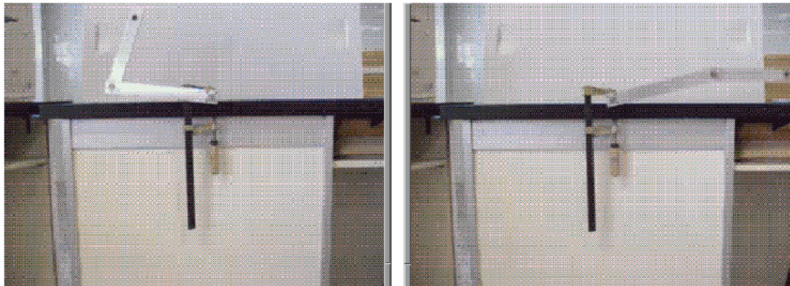
Figura 11: Péndulo doble. Oscilaciones de alta energía. Comportamiento caótico.
