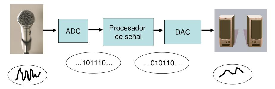
Se disminuyen los problemas de ruido analógico, ya que el ruido en los datos digitales no influye en su valor. La pérdida de precisión del sistema digital debida a la cuantificación es menor que la debida al ruido en el sistema analógico. Además, mejoran la manipulación de datos mediante circuitos más rápidos y flexibles.
