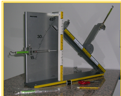
Figura 2. Las fuerzas ejercidas por los dinamómetros compensan el peso del cuerpo rodante. La reacción del plano inclinado es cero en ese caso.
