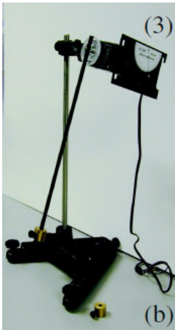
Figura 3. El plano de oscilación del péndulo forma un ángulo con el plano vertical que puede medirse con la ayuda de la plomada y la escala angular (3).
