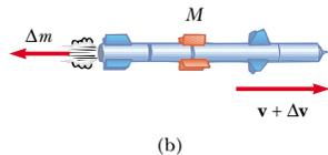
Si el carburante se expulsa con velocidad relativa  $v_e$  con respecto del cohete, la velocidad del carburante con respecto de un sistema de referencia estacionario es  $v - v_e$
