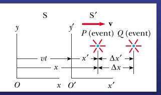
Según Galileo,  $\Delta x = \Delta x'$ , esto es la distancia entre los puntos del espacio en los que tienen lugar los sucesos no depende del movimiento del observador
