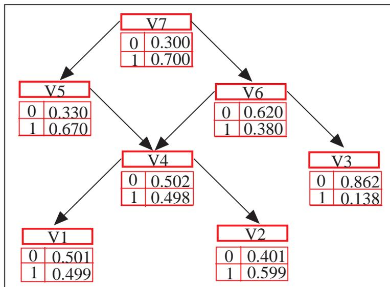
Sin embargo, cuando se observa cierta evidencia (supongamos que  $V1=1$  y  $V3=1$ ), las nuevas probabilidades condicionadas muestran el efecto de la evidencia en el resto de los nodos. Este proceso se denomina propagación de evidencia pues ésta se propaga por el grafo actualizando las probabilidades de los nodos.
