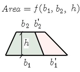
$f(b_1+b'_1,b_2+b'_2,k) = f(b_1,b_2,k) + f(b'_1,b'_2,k)$
